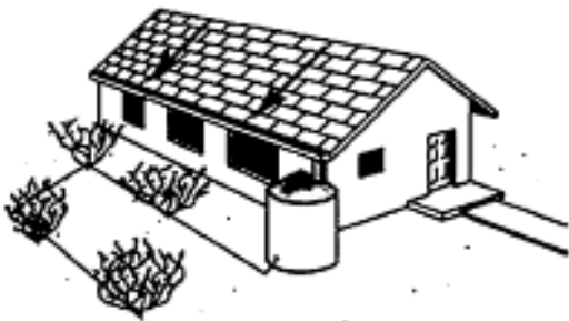
Regenwassernutzungssystem mit Dachsammeltonne, Regenrinne, Fallrohr, Speicher- und Tropfverteilungssystem. Quelle: Arizona Department of Water Resources. ©1998
