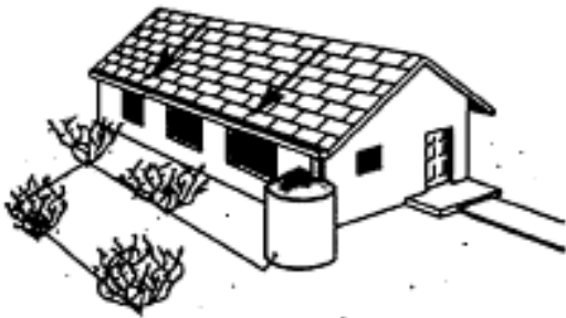
Sistema de recogida de agua con zona de captación en el tejado, canales, canalones, almacenamiento y sistema de distribución por goteo.
