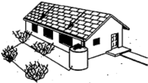
Sistema di raccolta dell'acqua formato da tetto, grondaia, pluviale, serbatoio e sistema di distribuzione a microirrigazione. Fonte: Arizona Department of Water Resources. ©1998
